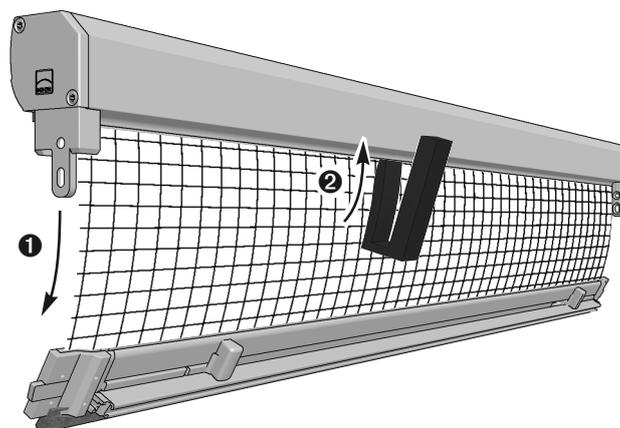
Rollokasten waagrecht und zum Blendrahmen ausrichten. Das Langloch anzeichnen, mit Steinbohrer  $\varnothing$  6 mm vorbohren, Dübel setzen und mit Schrauben SK 4,0 x 40 anschrauben. Waagrechte Position prüfen.
